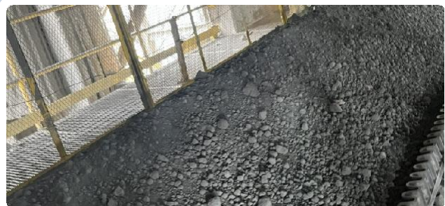
Granulometría y permanencia de clínker sobre la banda
